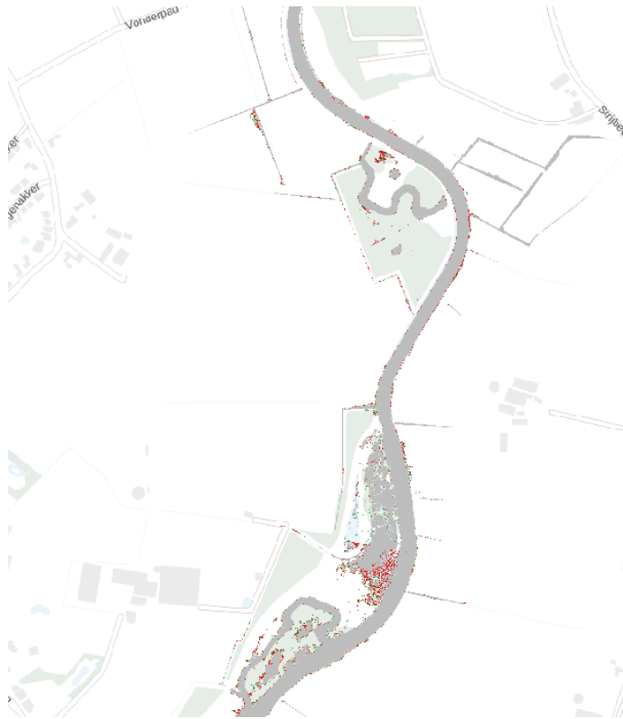
Figuur 26 Extra inundatie in T=2 scenario bij aanzanden van de Mark tot 1,50 m +NAP (rood) en DO inundatiebeeld zonder opslibben (grijs)
